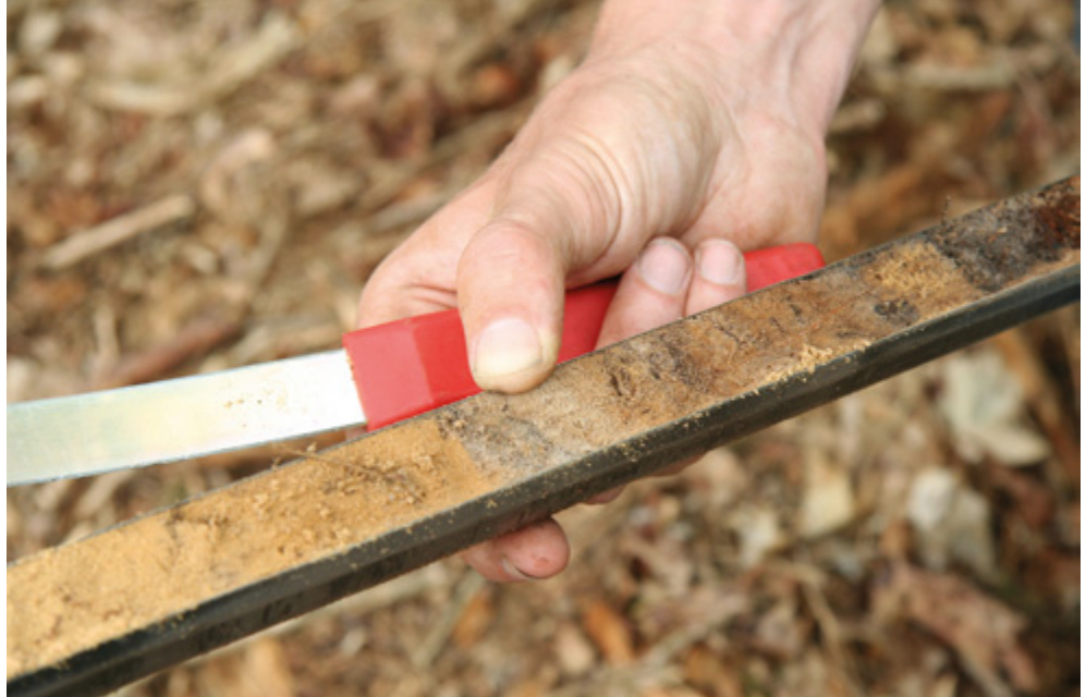
Afb. 3.1b De opbouw van de lage heuvels is met een gutsboor goed waar te nemen.
